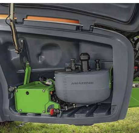
△ Die Dosierpumpe saugt das Mittel aus einem separaten 50-l-Tank.
