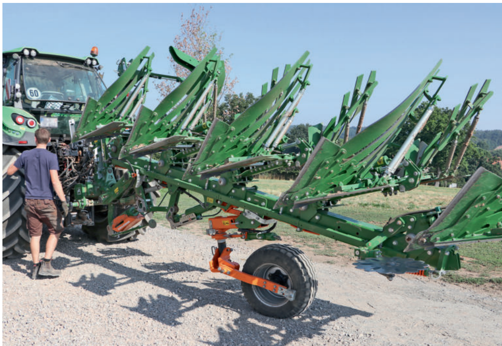
Das Umstellen in den Transportmodus ist beim Teres mit dem Umstecken von zwei Bolzen am Kombirad schnell erledigt.
