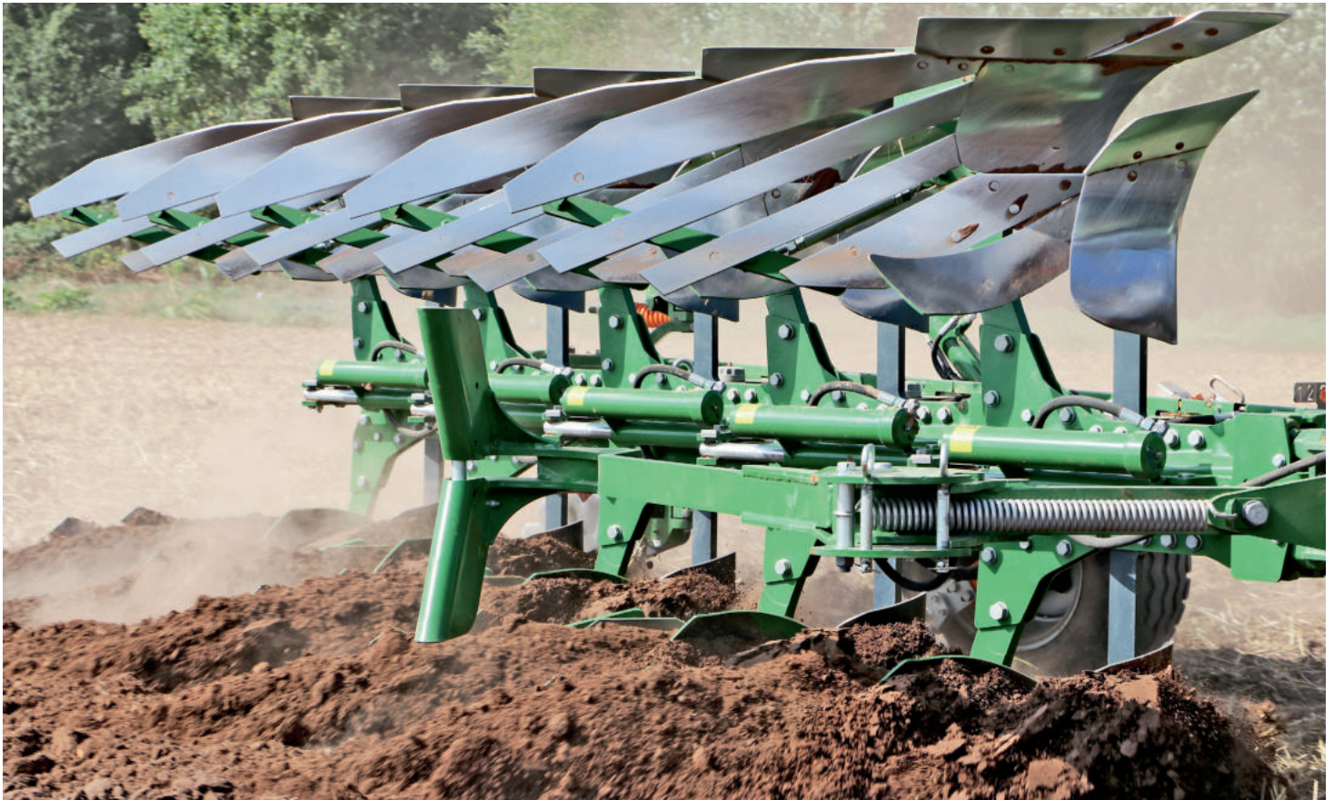
Die Streifenkörper am Teres 300 sind hydraulisch gegen Überlast gesichert. Das Pflugbild hat uns gefallen.
